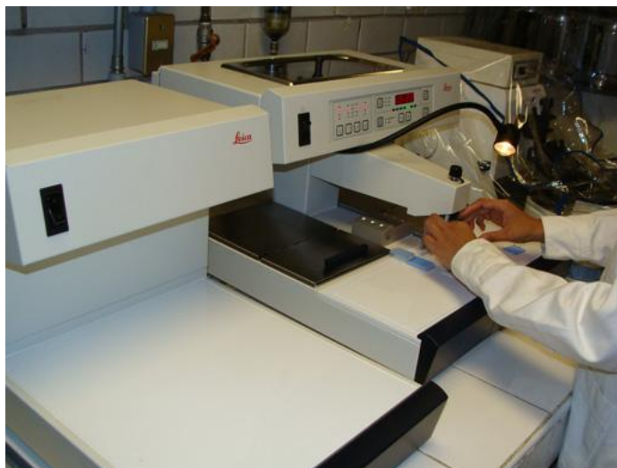
Fig 4. Placa de enfriamiento y centro de inclusión
